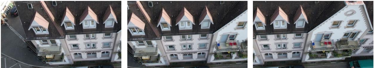
Bilderserie mit einer Überlappung von 60 – 80 %, 1/3 Dach, 2/3 Fassade
